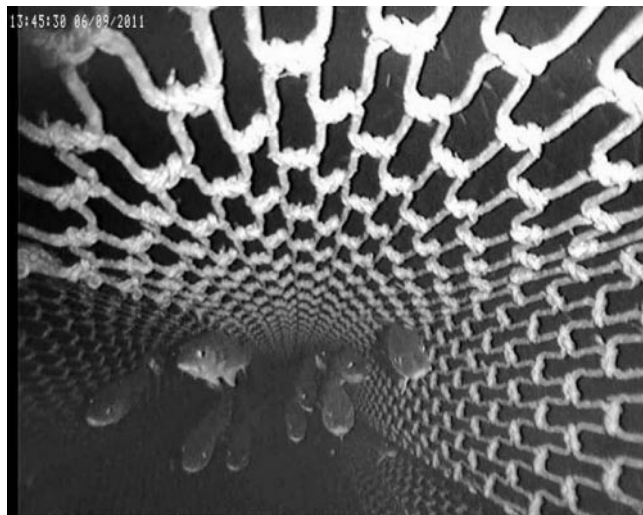
Fot. 1. Wódek T90 wykonany z podwójnego sznurka PA, na bębnie sieciowym kutra Katrine Kim (fot. Ulrik Jes Hansen, CATch-Fish)
