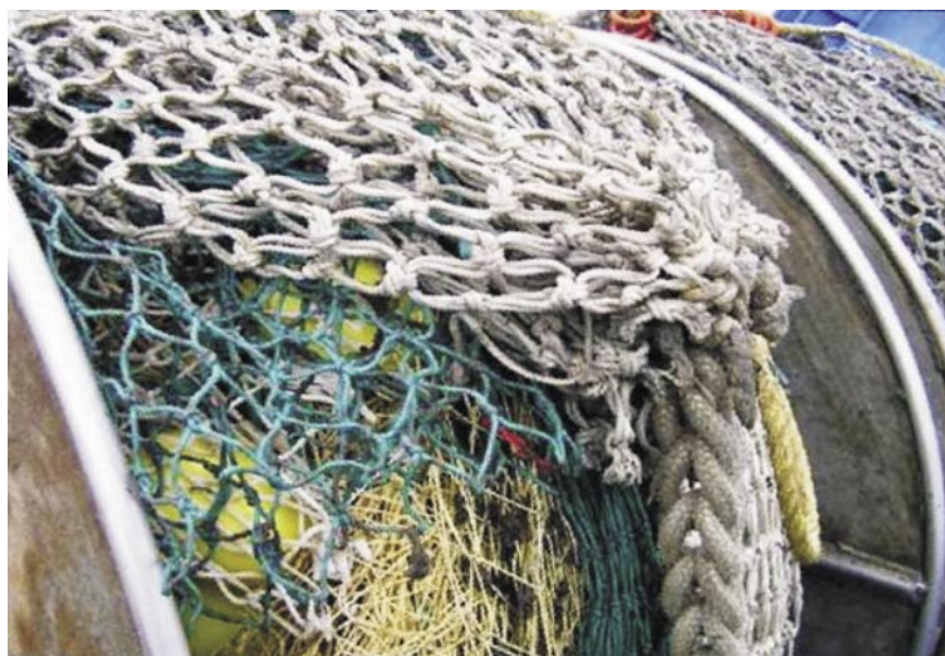
Fot. 1. Wódek T90 wykonany z podwójnego sznurka PA, na bębnie sieciowym kutra Katrine Kim (fot. Ulrik Jes Hansen, CATch-Fish)
