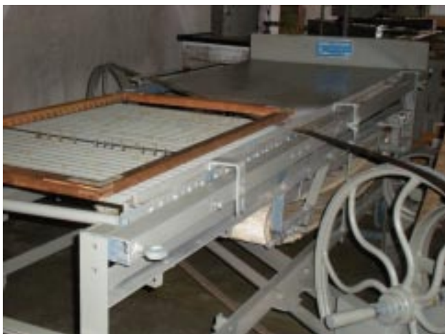
Fot. 2. Maszyna do odgławiania szprotów
