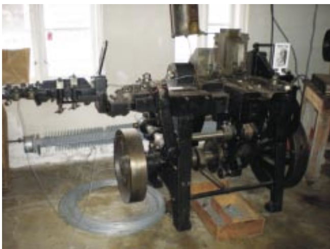
Fot. 3.. Maszyna do tłoczenia kluczyków do konserw
