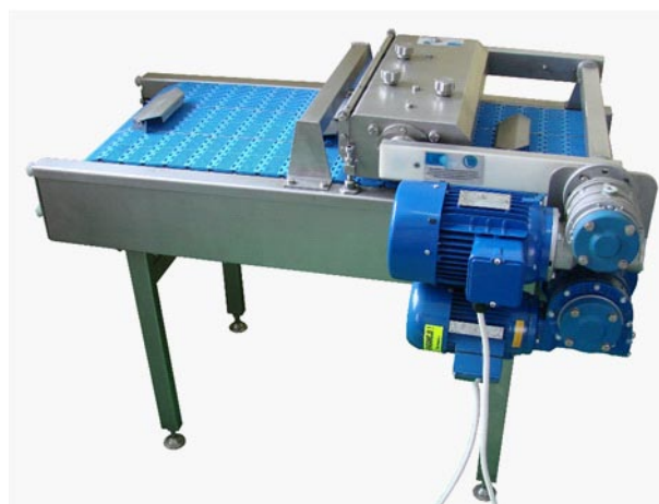
Rys. 1. Maszyna do przecinania ości w płatach karpi wykorzystana do tworzenia produktów wystawianych na Polfish 2015
