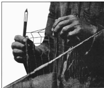
Fot. 2. Ręczne osadzanie węzłowej tkaniny sieciowej (Znamierowska-Prüfferowa, 1930 – Rybołówstwo Jezior Trockich).
