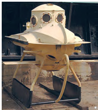
Fot. 5. Pojazdy podwodne bez własnego napędu z suchą kabiną, przeznaczone do obserwacji trałów, sieci, dna itp., (konstruktor: Antoni Dębski. Po lewej: „Delfin I” eksponowany na tarasie Akwarium Gdynińskiego, następnie przekazany do Narodowego Muzeum Morskiego (fot. http://zbiory.nmm.pl/node/457/pdf ). Po prawej: „Delfin II” opuszczony z pokładu r.v. „Profesor Siedlecki” (fot. ze zbiorów Mariana Smorawskiego).
