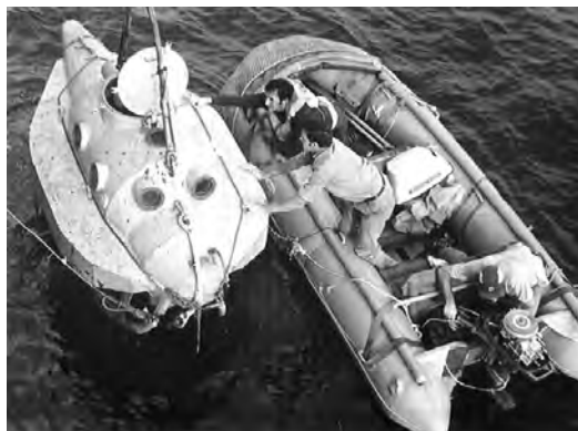
Fot. 5. Pojazdy podwodne bez własnego napędu z suchą kabiną, przeznaczone do obserwacji trałów, sieci, dna itp., (konstruktor: Antoni Dębski. Po lewej: „Delfin I” eksponowany na tarasie Akwarium Gdynińskiego, następnie przekazany do Narodowego Muzeum Morskiego (fot. http://zbiory.nmm.pl/node/457/pdf ). Po prawej: „Delfin II” opuszczony z pokładu r.v. „Profesor Siedlecki” (fot. ze zbiorów Mariana Smorawskiego).
