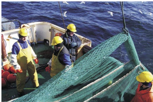
Fot. 6 i 7. Dłonie włók dorszowych typu T90 (po lewej) i z „oknem Bacoma” w worku włoka (po prawej), stosowane do badań selektywności tych narzędzi w odniesieniu do dorszy bałtyckich (fot. W. Moderhak).
