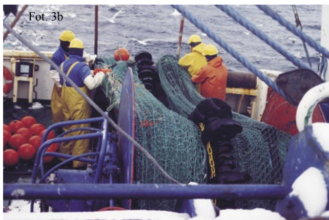
Fot. 3a i 3b. Denny, dorszowy, standardowo uzbrojony, drobnoczkowy włók typu TV-3#930 (górny), od listopada 1999 r. stosowany w rejsach typu BITS, wraz z nowym wyposażeniem technicznym, tj. oscylatorem echosondy badawczej zamontowanym w nadborze oraz ww. typ włoka z tzw. ciężkim uzbrojeniem (rock-hopper) – gumowymi dyskami, stosowany do połowów ryb na twardym gruncie wschodniego Bałtyku (dolny).
