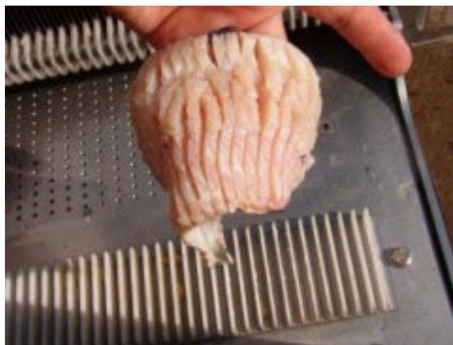
Nagrodzona maszyna do przecinania ości w filetach (Fot. R. Geremek)
