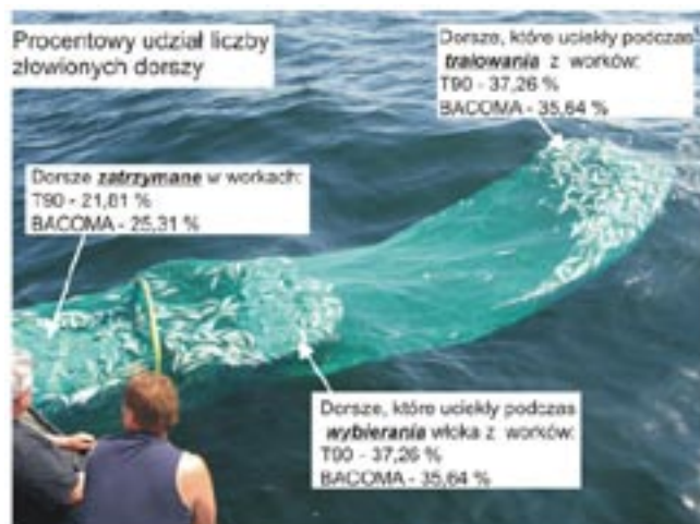
Rys. 6. Kuter WŁA-71, wybieranie worka z dzieloną okrywą – procentowy udział ilości zatrzymanych dorszy
