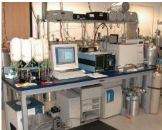
Rys. 3 Aparatura analityczna gazów cieplarnianych, Boulder, Colorado; z lewej strony monitora 7 białych oznakowanych numerami, specjalnych butli, w które pobierane są próby powietrza w całym systemie monitoringu (źródło – http://www.cmdl.noaa.gov/ccgg/images/magics.jpg )
