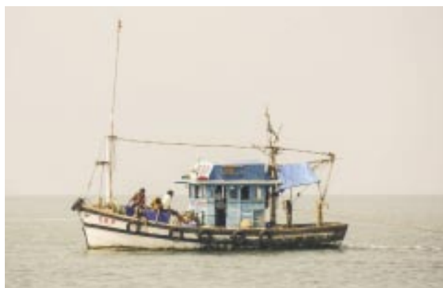
Drewniany kuter wyposażony w silnik i wciągarkę włoka
