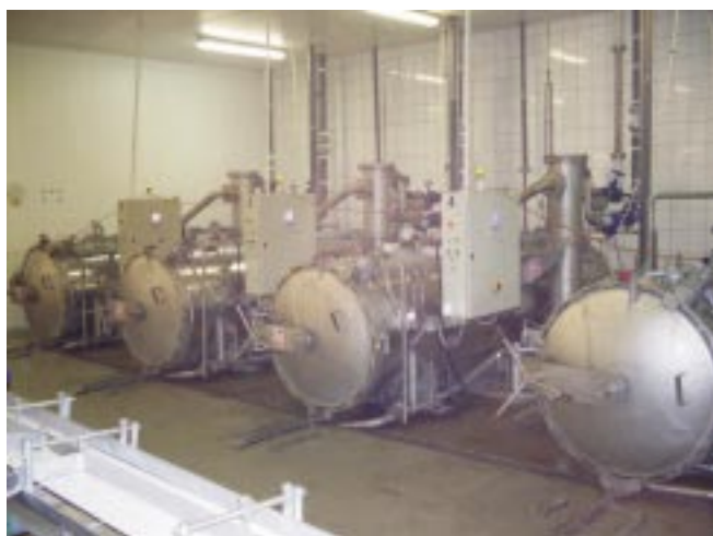
Fot. 1. Bateria prototypowych autoklawów zroszeniowo-kaskadowych
