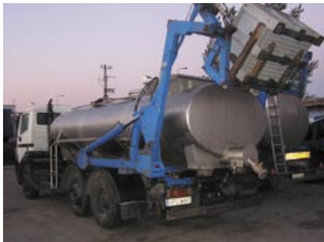
Samochody-cysterny (izotermiczne) z hydraulicznym systemem załadunku surowca – odpadów rybnych
